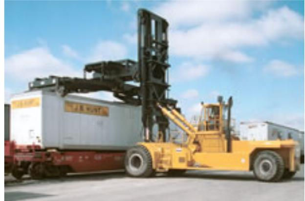
Figure 30 – Machine à levage par le haut Taylor 974 (Taylor Machine Works)
